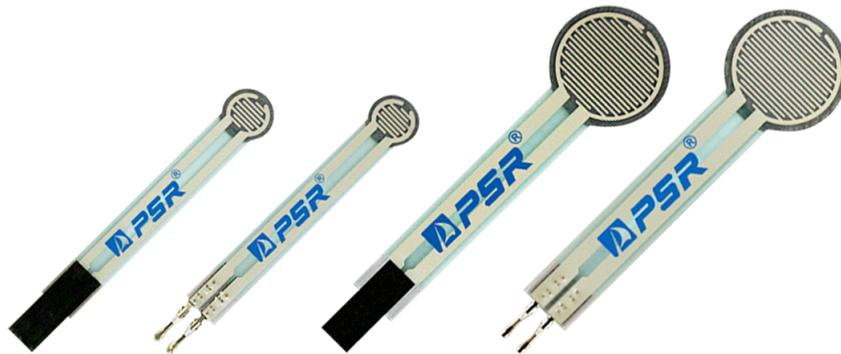
PSR<sup>®</sup> 제품은 압력/힘 감지 센서로서, PSR 센서의 입력부 표면에 인가된 압력/힘의 증감에 따른 저항의 변화 값을 측정할 수 있는 제품입니다. 자동차 전자장치, 로봇의 어플리케이션, 전자음악장비와 같은 사람의 접촉을 통해 제어할 수 있도록 설계되었습니다. 다양한 형태와 길이로 제작이 가능하고, 내구성을 보유한 제품으로 고객의 사양에 맞게 측정범위 또한 조절할 수 있습니다. 또한, ON/OFF 스위치 정도로 사용할 수 있는 기존 제품과는 달리 Linearity(직선성)이 우수한 제품으로, 특정 구간에 대한 측정이 뛰어납니다.
